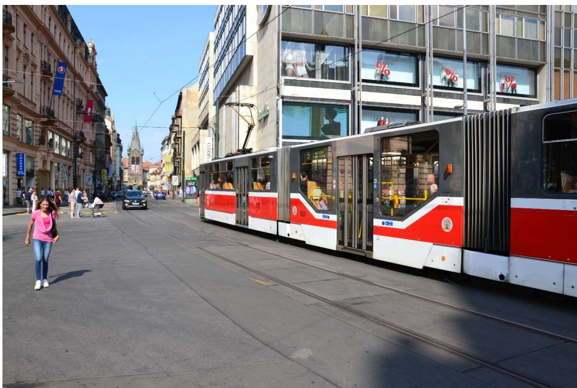
Rysunek 61. Dwukierunkowy tramwaj Tatra KT8D5R.N2P z niskopodłogową, zmodernizowaną sekcją środkową, Praga (2018) Foto: O. Pietrzak
