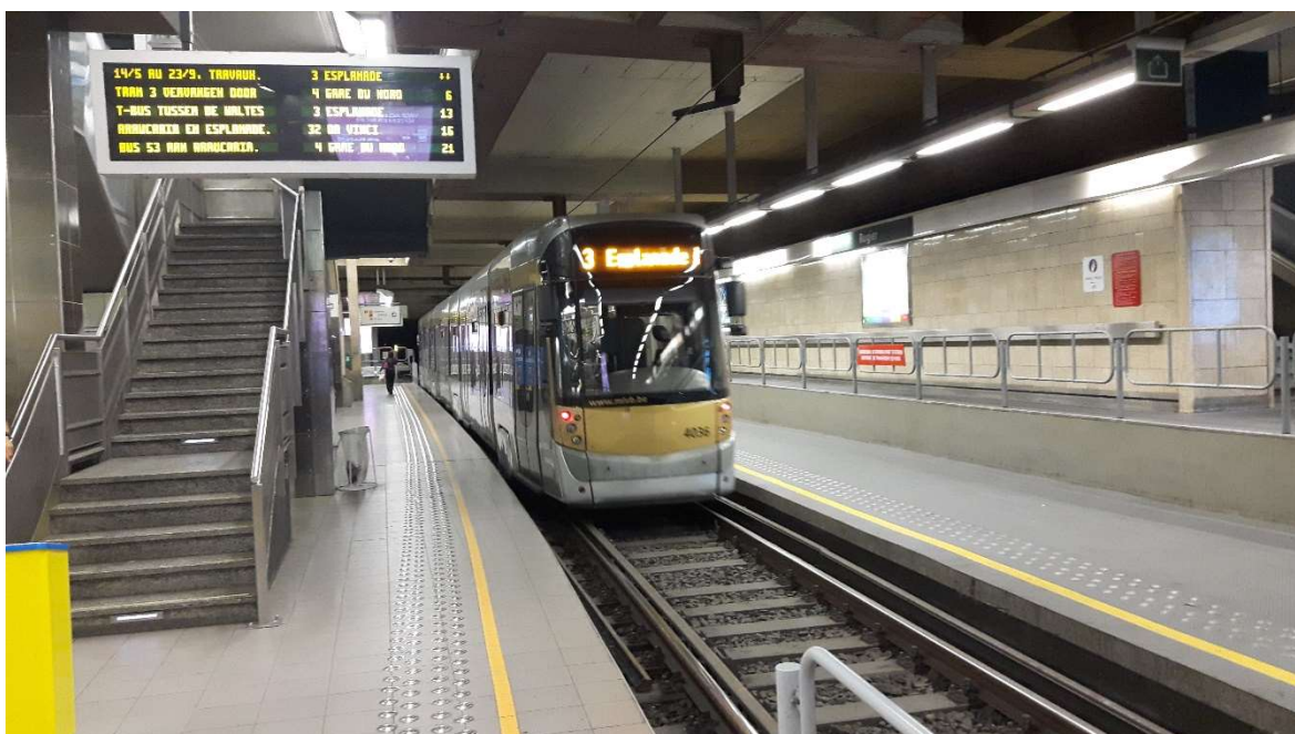
Rysunek 10. Przystanek tramwajowy umożliwiający obsługę pasażerów z dwóch stron pojazdu, przystanek „Rogier”, Bruksela (2018) Foto: K. Pietrzak
