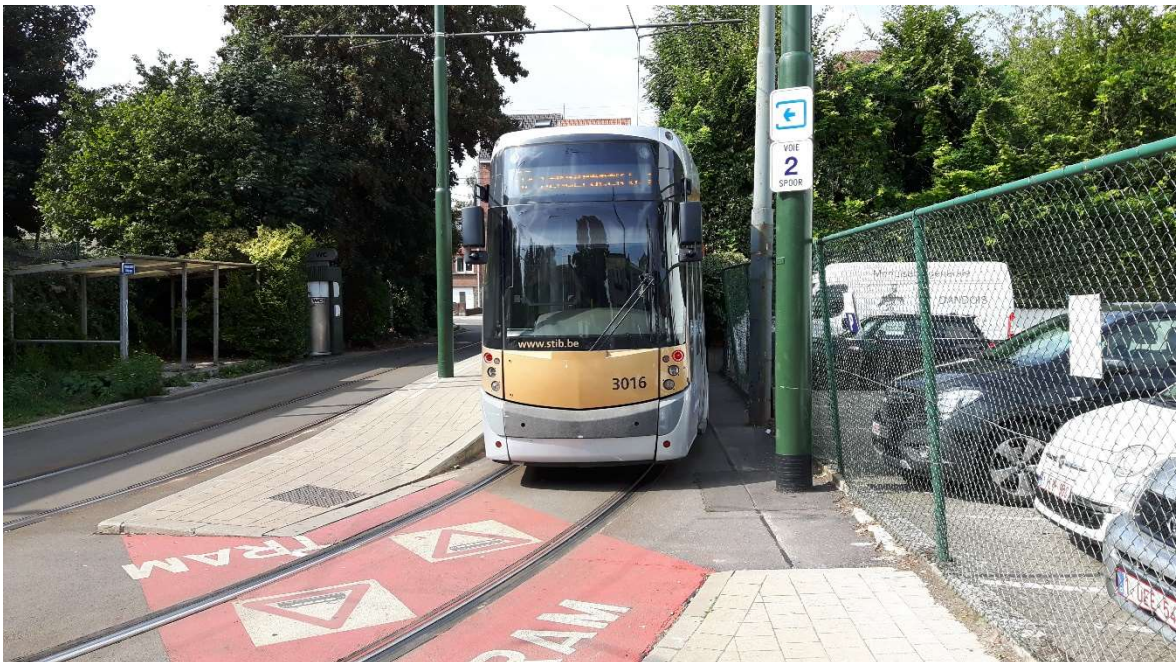
Rysunek 4. Wykorzystanie tramwaju dwukierunkowego w miejscach o utrudnionym dostępie do środka transportu od strony prawej, pętla tramwajowa „Fort-Jaco”, Bruksela (2018)
